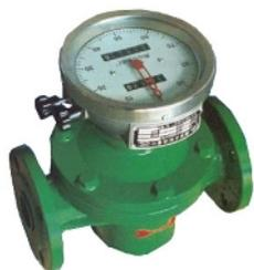
Расходомеры серии OGM позволяют точно измерять количество топлива, керосина, масел и других вязких жидкостей, по отношению к которым материал, из которого изготовлен счетчик, устойчивы. Принцип измерения с овальными шестернями обеспечивает высокую точность измерения в широком диапазоне вязкости перекачиваемой жидкости. Счетчик комплектуется механическим циферблатом (опционально импульсным выходом).
