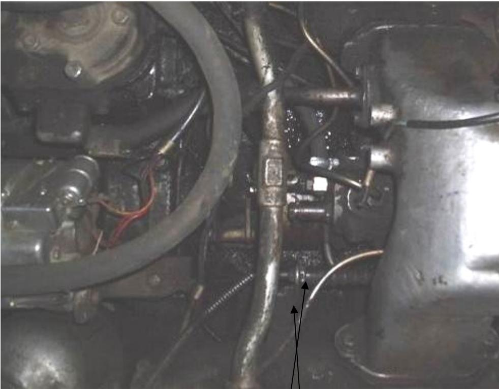
На место обратки в ТНВД закручиваем пробку. Без усилия, просто наживить. Ее придется открутить для прокачки системы.
