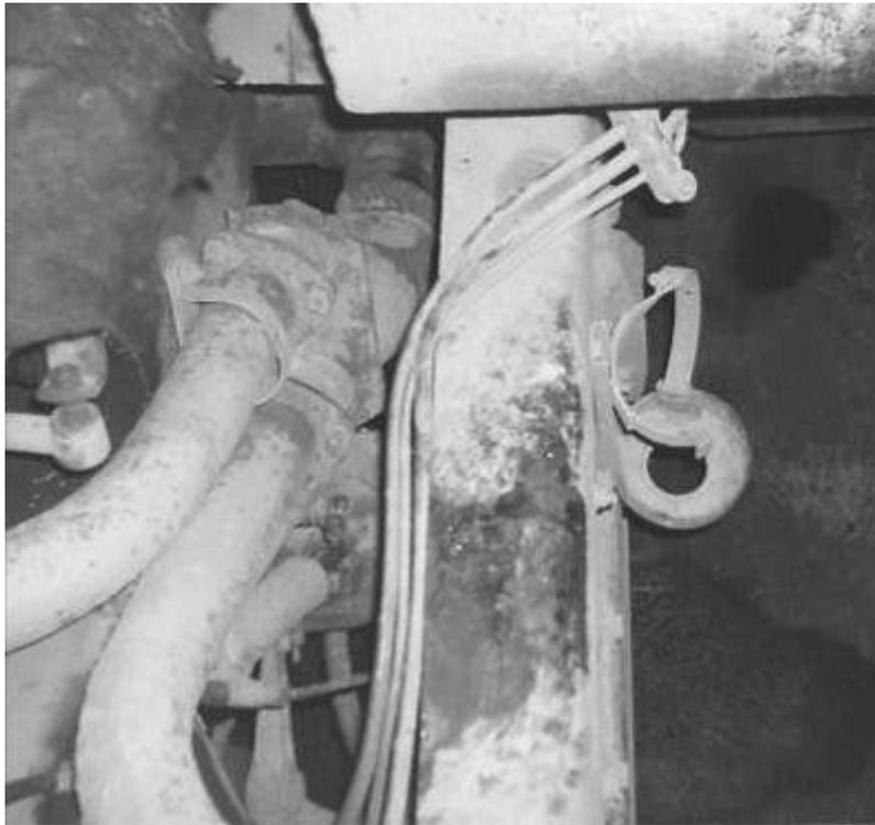
На раме возле бака можно увидеть 3 медные трубки – это подача топлива в двигатель из бака, возврат основной обратки (с ТНВД и фильтра) и тонкая трубка обратки форсунок, которую мы не глушим. ПО ней в бак возвращается топливо посчитанное счетчиком но вернувшееся в бак – на эту величину счетчик показывает БОЛЬШЕ реального расхода!
